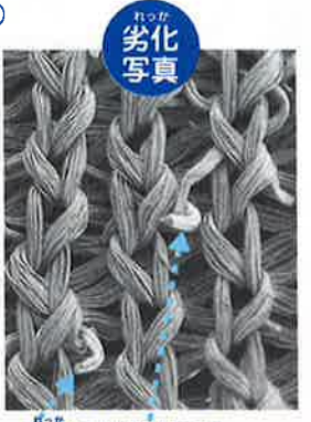
劣化によりポリウレタン糸が 所々断裂した状態の生地表面。
